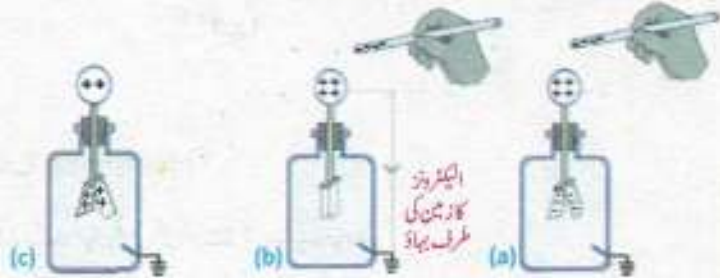
شکل 13.8: ایلیکٹروسکوپ کو پوزیٹیو طور پر چارج کرنے کا عمل
